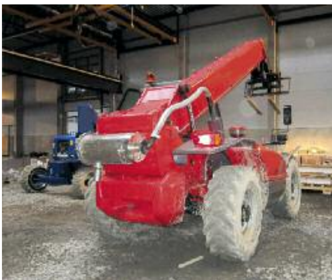
Abb. 1: Mit DPF nachgerüstete Hubarbeitsbühne
