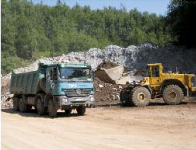
Abb. 5: Bei Bauarbeiten im Freien sind i.d.R. keine Schutzmaßnahmen gegen Abgase von Dieselmotoren erforderlich
